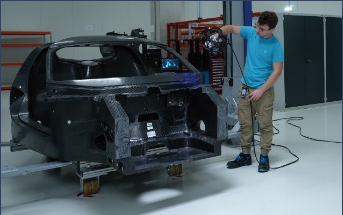
Inspektion und Qualitätskontrolle von CFK-Monocoques für Hypercars mit FreeScan Trak Pro2
