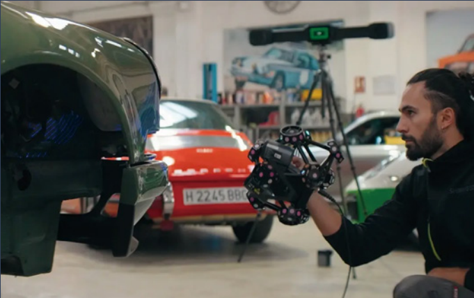
Oldtimer Karosserievermessung per 3D-Scan: SHINING 3D unterstützt Juliá Automobile bei der Porsche-Restaurierung Erfahren Sie mehr
