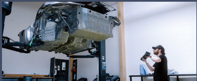
Überprüfung der Unfallrestauration
